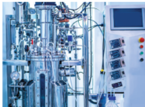
Биореактор за индустриско производство на антибиотици
