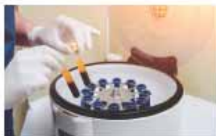
Лабораториска центрифуга со епрувети со крв што е разделена на составни делови
