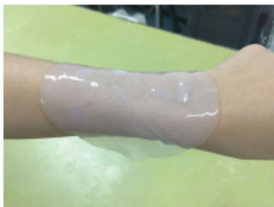
Бактериска целулоза произведена со помош на бактерии
