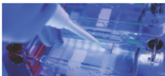
Поставување на примероци на агарозен гел за електрофореза
